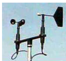
Sensor de velocidade e direção do vento
