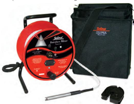
Se houver apenas água no poço, e nenhum produto, haverá apenas sinais intermitentes (água). A presença ou ausência de camadas densas (afundável) não aquosa (DNAPL) é determinada ao continuar abaixando a sonda dentro do poço continuamente.
