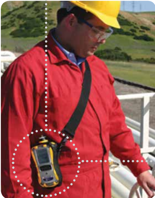
MultiRAE sendo utilizado para monitorar a exposição dos trabalhadores em refinaria de petróleo
