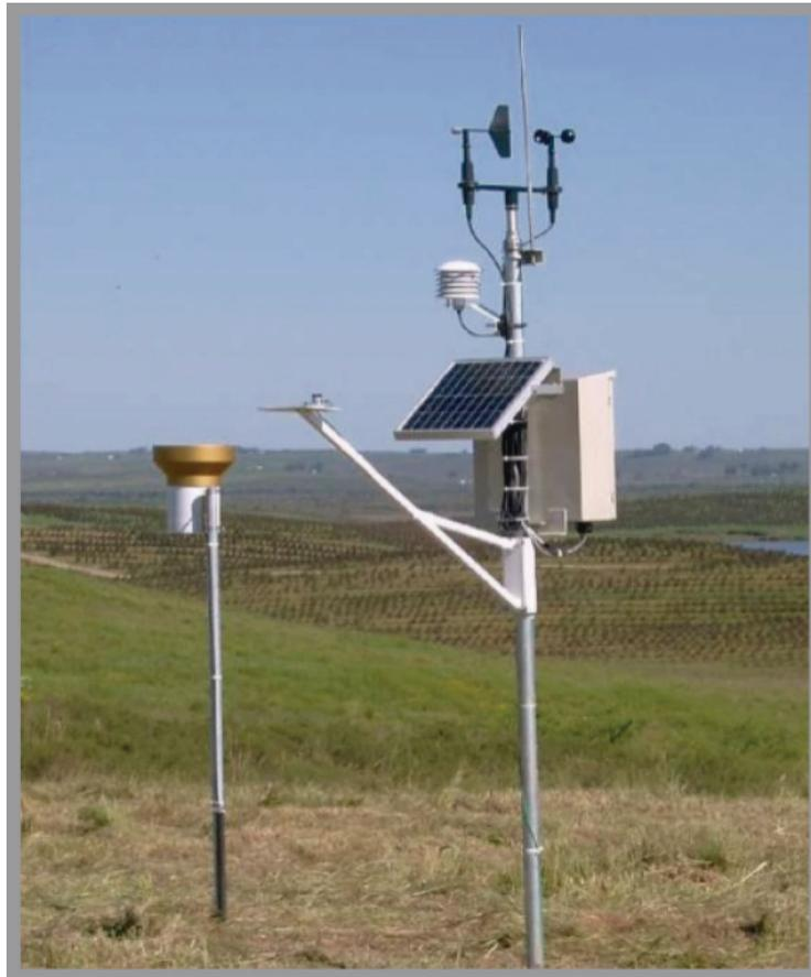
As estações meteorológicas automáticas da AgSolve são configuráveis e, geralmente, os sistemas compreendem à plataforma de coleta de dados, aos sensores e ao sistema de comunicação direta ou telemetria.
