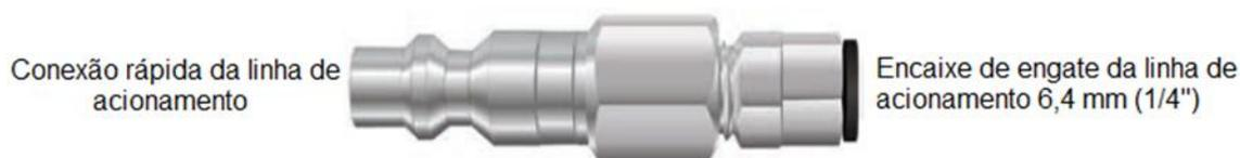
Quando a Bomba de Válvula Dupla for instalada sem a cabeça de poço ou carretel de tubulação, utilize um Adaptador de Linha de Acionamento para permitir a conexão rápida da linha de acionamento da Unidade de Controle até a linha de acionamento da tubulação da bomba.
