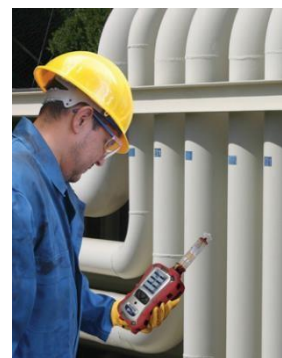
MultiRAE Benzene usado para detecção de vazamento
