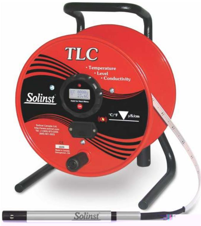
Na perfilagem da condutividade e temperatura em profundidade de corpos d'água, o medidor 107 da Solinst® possui características inigualáveis:
