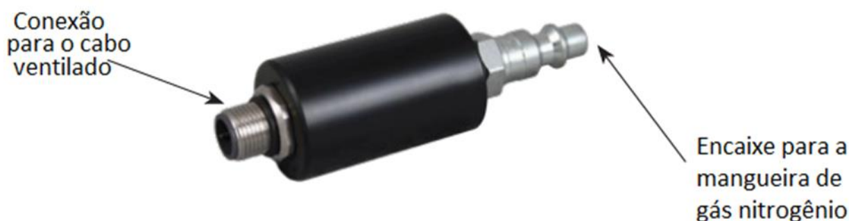
Figura 9-4 Encaixe de Sopro do Cabo Ventilado
