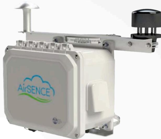
O equipamento realiza medições para grande parte dos poluentes gasosos, incluindo NO, NO<sub>2</sub>, CO, O<sub>3</sub>, SO<sub>2</sub>, VOC, H<sub>2</sub>S, CO<sub>2</sub>, NH<sub>3</sub> (amônia) e CH<sub>4</sub> (metano), além dos materiais particulado, PM<sub>10</sub>, PM<sub>2,5</sub> e PM<sub>1</sub>.
