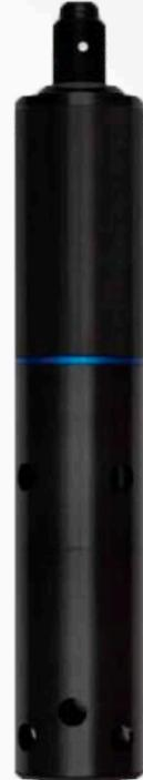
Sonda multiparâmetro para monitoramento fixo de longo período, com instrumento de auto-limpeza. Sensores padrão: OD óptico, CE, pH, ORP, Temperatura e Profundidade. Possui 6 portas adicionais para qualquer combinação de eletrodos ISE e/ou ópticos.
