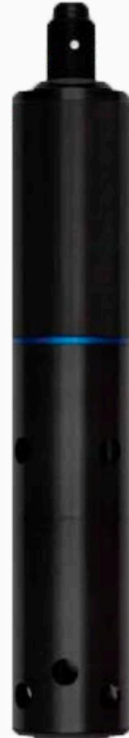
A sonda multiparâmetro AP-7000 foi desenvolvida para operar durante longo período de tempo, permitindo monitorar até 19 parâmetros simultaneamente. Além dos 11 parâmetros padrão – OD Óptico, CE específica e absoluta, pH, ORP, TDS, Resistividade, Salinidade, Gravidade Específica do mar, Temperatura e Profundidade – a sonda possui 6 portas auxiliares para inserção de outros eletrodos definidos pelo usuário, em qualquer combinação.
